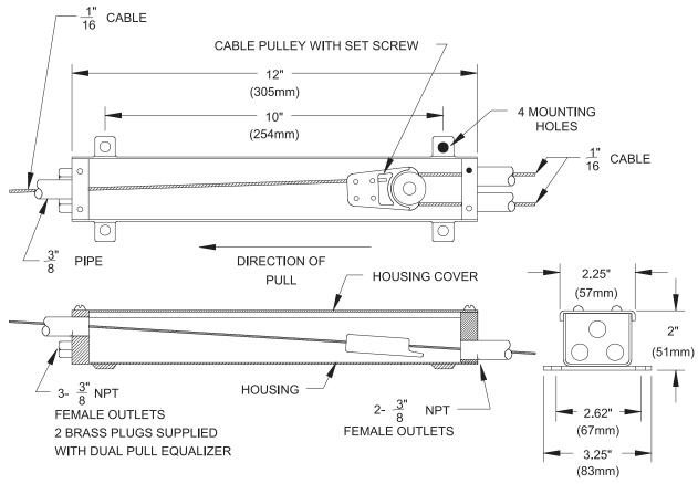
USE  $\frac{3"}{32}$  HEX KEY FOR CABLE PULLEY SET SCREWS.
